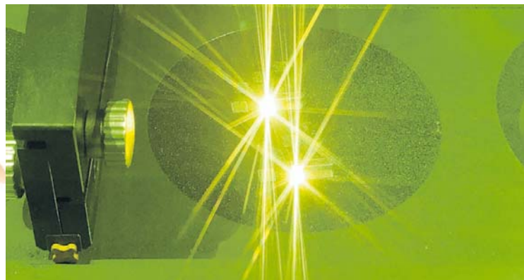
Im 3-D-Drucker wird ein Pulver per Laserstrahl verdampft. Im entstehenden Gas bildet sich Siliziumcarbid, dass auf dem Substrat kristallisiert. Schicht für Schicht entsteht ein extrem hartes Bauteil. Foto: PSC Technologies
