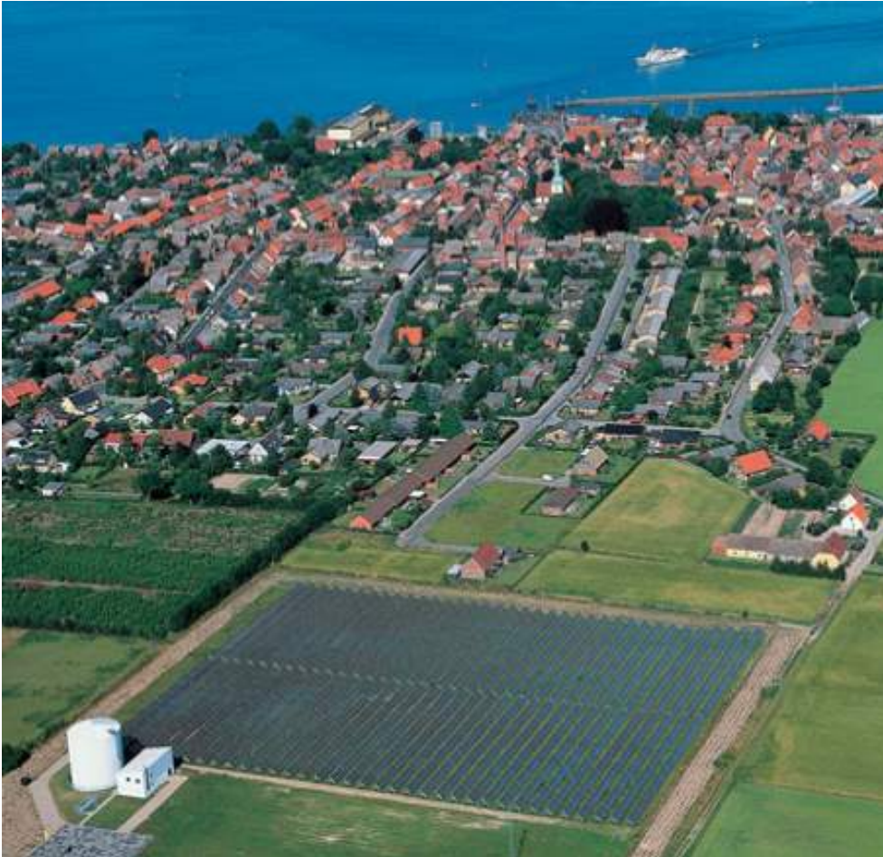
Chauffage solaire régional à Marstal, Danemark 17,000 m 2 aire de collecteurs
